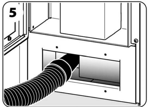
Pour un nettoyage complet, retirer les tôles du "Kit déflecteur des fumées" situées à l'intérieur du compartiment de collecte des poussières de l'échangeur.
