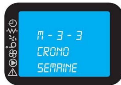
L'appareil dispose de quatre programmes hebdomadaires qui permettent quatre allumages et quatre extinctions par jour. Chaque programme propose une rotation de neuf options de réglage/activation selon le tableau suivant.
