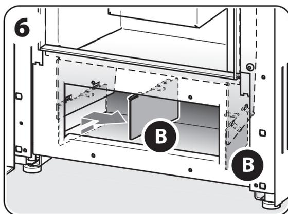
7. Vider le compartiment à l'aide d'une petite pelle, puis aspirer la suie et les cendres restées à l'intérieur du compartiment de collecte des poussières de l'échangeur.
