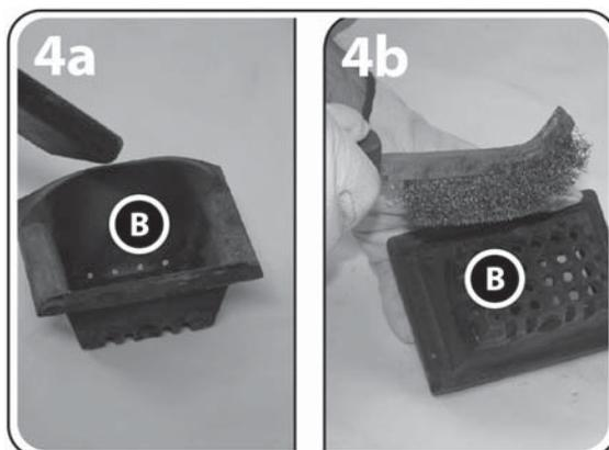
5. Retirer le cendrier de la chambre de combustion [H] pour le vider.
