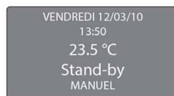
C'est seulement lorsque la température ambiante redescend en dessous de celle définie de -1°C et que l'appareil a terminé son cycle d'extinction qu'il se rallume en passant à l'état de fonctionnement [Redémarr.].
