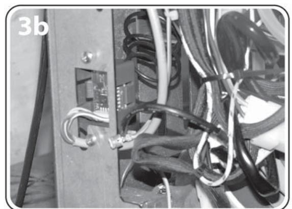
4. Remettre en place la carte électronique en vissant les 3 vis de fixation.
