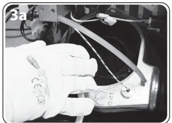
4. Aspirer la suie qui s'est déposée sur les pales en inox de l'extracteur de fumées [Q].
