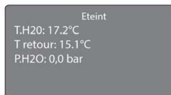
Appuyer sur le bouton [P6] pour afficher le deuxième écran d'état du système qui contient des informations sur la température de l'eau de refoulement, la température de l'eau de retour et la pression de l'installation.
