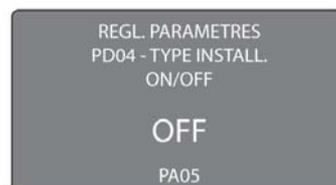
En cas d'activation du type d'installation 2 ou 3, l'appareil affiche également la fonction [ETE] qui permet, si le réglage est [ON], de dévier la sortie d'eau chaude sanitaire [26-27-28] de la carte électronique sur la production d'eau chaude sanitaire. Cette fonction est disponible en appuyant deux fois sur le bouton [P4] à l'écran principal.
